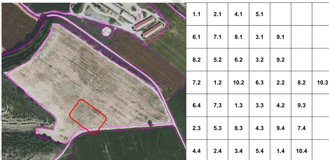
Figura 1: Imagen de la parcela y la zona elegida para el ensayo y esquema del ensayo de eficacia de herbicidas para el manejo de coniza con las repeticiones de cada tratamiento distribuidas al azar. Cada Repetición cuenta con 4 árboles.
