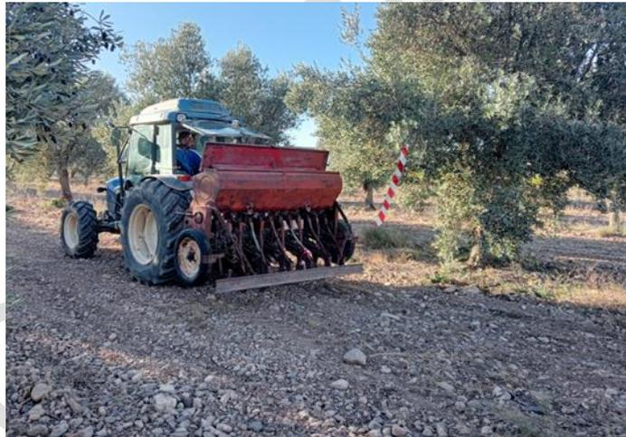
Figura 2. Sembradora de cereal utilizada para la implantación de las cubiertas vegetales.
